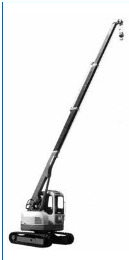
2.9t後方小旋回／4段ブーム※標準型
