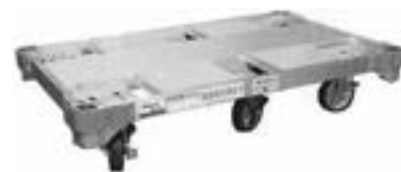
アルミ平台車 床寸法 1200L×745W (外形寸法 1230L×775W) 質量 28.0kg キャスター仕様(H社製) φ150 ナイロンホイルウレタン車 定格重量 1t
